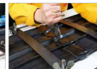
Aplikácia krycích pásov; stlačenie oboch krycích pásov
