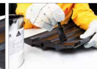
Nanášanie vulkanizačného roztoku na gumovú plochu
