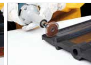
Brúsenie gumového povrchu
