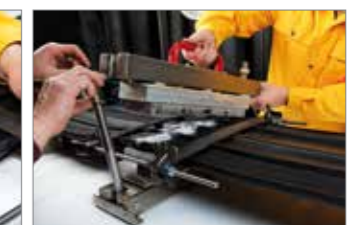
Nanesenie prášku na tesniaci pás a vloženie do vulkanizačného zariadenia
