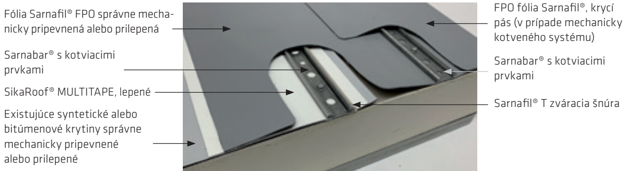
3. Rozvinutie novej hydroizolačnej strešnej fólie Sarnafil® FPO.
