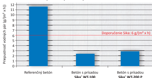
Výrazné zníženie priepustnosti vodných pár použitím prísad rady Sika® WT
