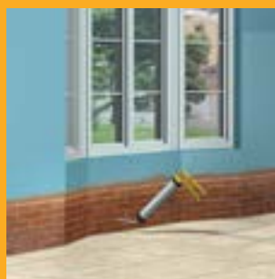
Vsuňte trysku až na dno otvoru. Vytlačajte injektážnu hmotu a zároveň vysúvajte trubicu. Vyplňte otvor až do 1 cm od jeho konca.
