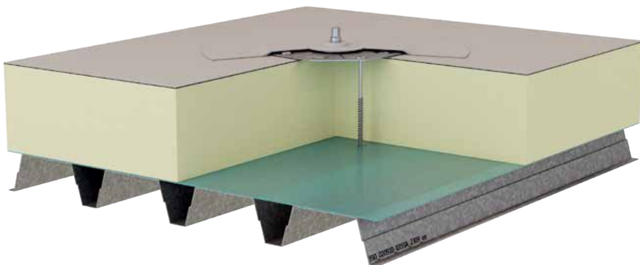
Kotviaca podložka SikaRoof® 140 mm upevnená s upevňovacím prvkom Sarnafast® SBF-6.0.
