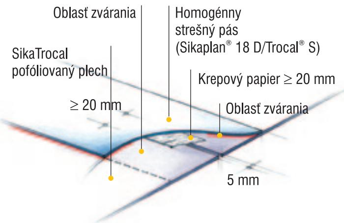
Ak je potrebné vystuženie profilov, spojenia profilov sa podložia podložkami, prispôsobenými tvaru profilu. Pri odkvapoch, strešných okrajoch a profiloch na pokrytie muriva sú potrebné dodatočné podložky kvôli očakávanému namáhaniu v dôsledku veterného zaťaženia. Volne ležiace hrany pofólioovaného plechu musia byť žlabmi alebo priehybmi chránené pred poveternostnými vplyvmi.
